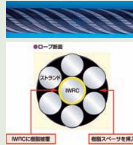
半被覆ロープは、ロープ心に樹脂被覆を施し、さらにストランド（子繩）間に樹脂スペーサを挿入することで、ストランド間の金属接触を防止し、シーブとの接触面圧の軽減を実現した製品であります。
