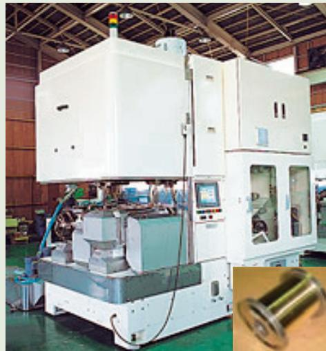
太陽光をエネルギーとする太陽電池は、CO<sub>2</sub>を排出する化石燃料を使わない再生可能なエネルギーの発電装置であります。当社では太陽電池の原料であるシリコン結晶インゴットをスライスしてウェハーを生産する装置であるワイヤソーおよびスライスに使用する太さ120～160ミクロン程度の極細ワイヤであるソーワイヤを製造販売しております。ワイヤソーは2軸のロールにソーワイヤを等間隔に巻きつけ、その軸間にシリコン結晶インゴットを押し付けることにより厚さ180ミクロン～200ミクロンという薄いシリコンウェハーを製造いたします。したがってワイヤソーはミクロン単位の高精度が求められる機械装置であります。
