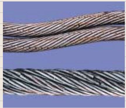
ロープ内部の圧こんと断線状況。
