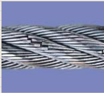
擦りへり摩耗面の断線。
