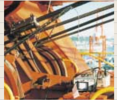
ワイヤロープテストによる測定例
