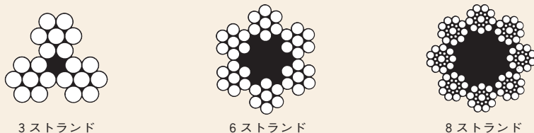
図3-2 ストランド数別ワイヤロープの断面例
