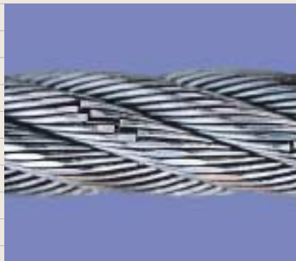
擦りへり摩耗面の断線。
