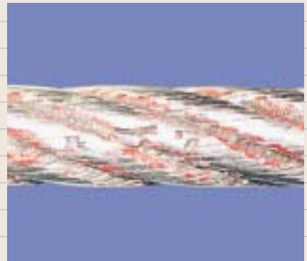
潰れ摩耗による断線。
