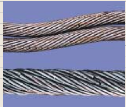
ロープ内部の圧こんと断線状況。
