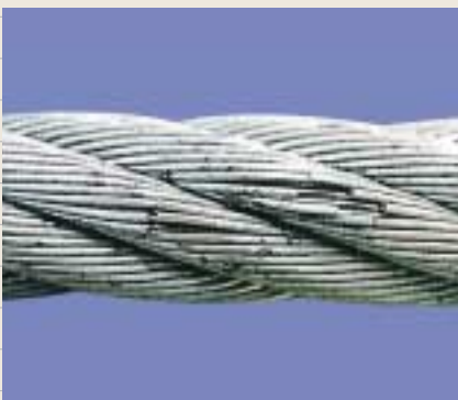
使用頻度が多く、外部に曲げ疲労断線が発生。
