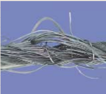
断線により発生した切断事故後の状況。
