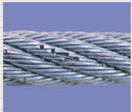
擦りへり摩耗と曲げ疲労による断線。
